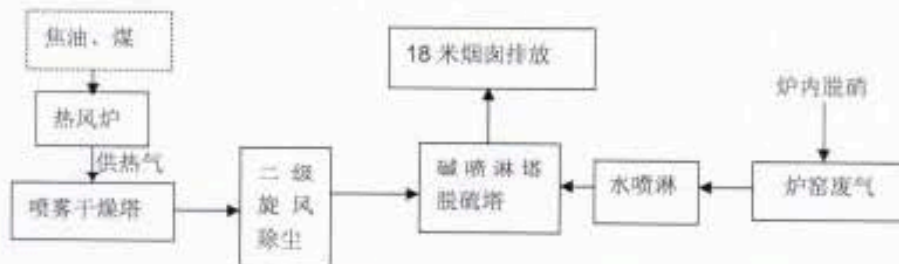
图 1 喷雾干燥塔废气、炉窑废气处理工艺图
