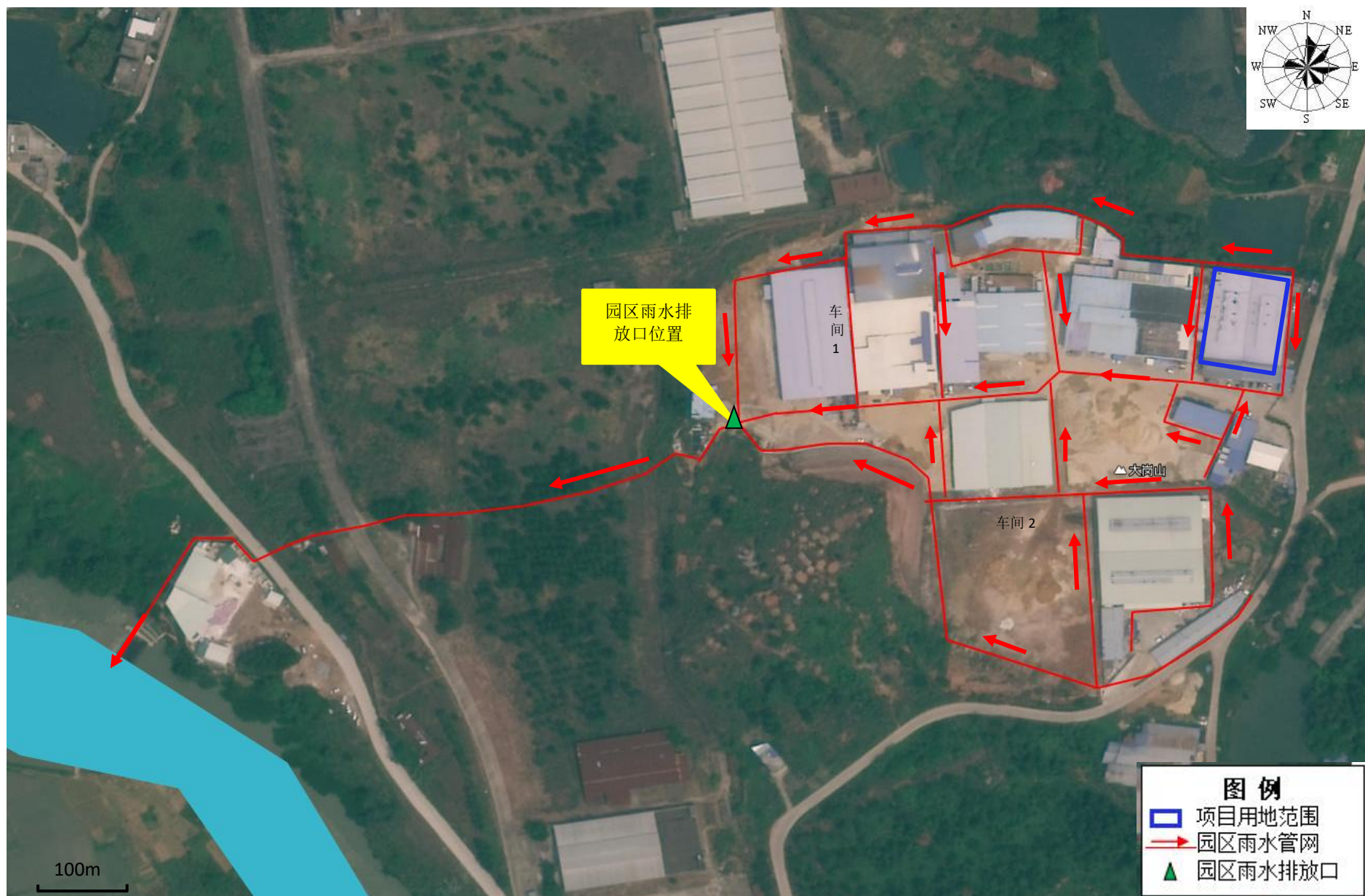
图 6.4-3 区域雨水排放与围底河水力联系图
