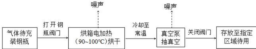
图 2-5 气体待充装钢瓶预处理工艺流程图
