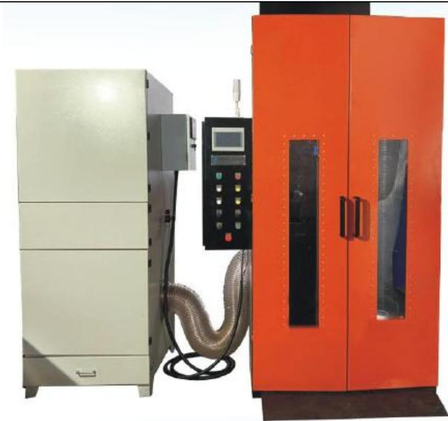
图 2-3 项目钢瓶除锈机及配套集尘柜
