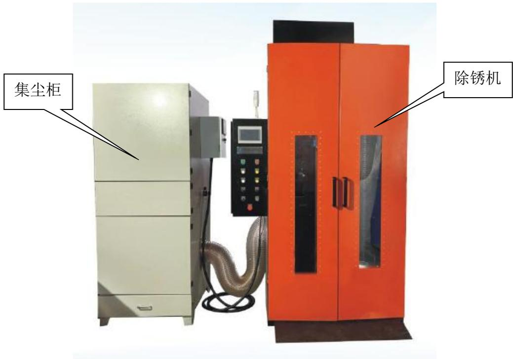
图 4-1 立式钢瓶自动除锈机
